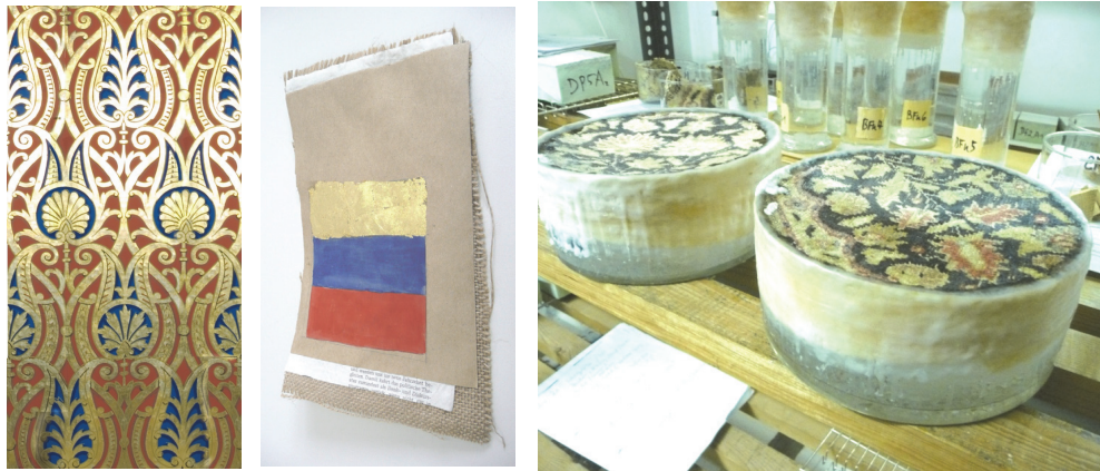
Bild 24: Messung der Materialkennwerte an nachgestellten historischen Materialien. Links: originale Tapete, Mitte: nachgestellte Tapete mit Leinwandträger, Zeitung, Packpapier, Farb- und Goldfassung, Rechts: historischer Teppich bei der Diffusionssmessung in der Klimakammer. (Fotos: Fraunhofer IBP Kristina Holl / Barbara Wehle)
