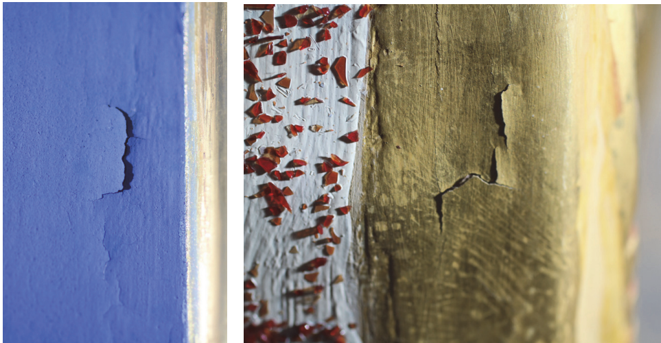
Bild 3: Klimatisch bedingte Ablösung der blauen Fassung und Vergoldung am Altar der Kirche St. Margaretha in Roggersdorf im Jahr 2009, fünf Jahre nach der Restaurierung und Neufassung des Altars. (Fotos: Kristina Holl, Fraunhofer IBP)
